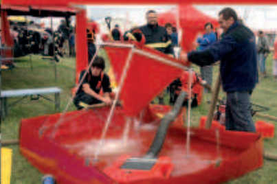
→ Skládací zó- chytňá vana určená pro záchyt a dekontami- naci
