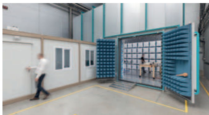
EMC komora o rozměrech 7,8 × 5,3 × 4,8 m vybavená měřicím systémem do 26 GHz umožňuje i pokročilé testy s aktivním chlazením napájených komponentů nebo odtahem spalin.
