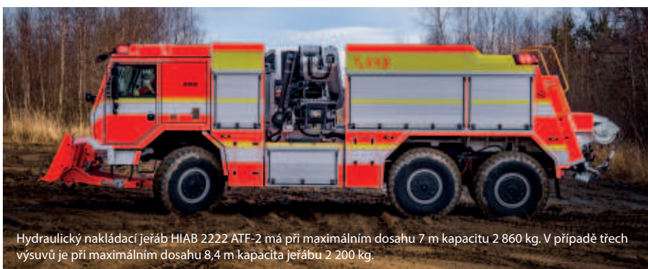
Hydraulický nakládací jeřáb HIAB 2222 ATF-2 má při maximálním dosahu 7 m kapacitu 2 860 kg. V případě třech výsuvů je při maximálním dosahu 8,4 m kapacita jeřábu 2 200 kg.
