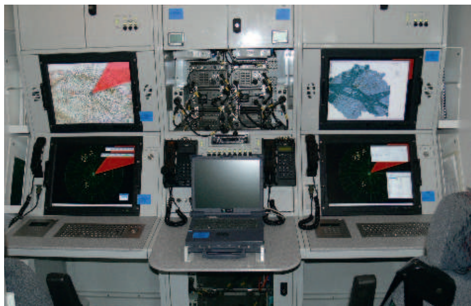
RACCOS - systém velení a řízení zpracovává informace o vzdušné situaci, rozdělení cílů a působení na jednotlivé cíle
