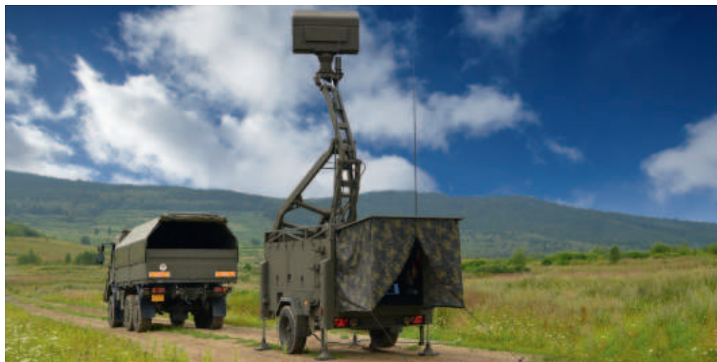
ReVISOR - komplexní systém složený z radaru krátkého dosahu a systému velení a řízení
