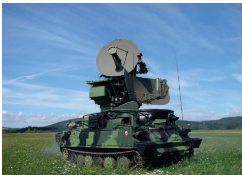
Modernizace SURN - kompletní modernizace včetně přehledového a naváděcího radaru
