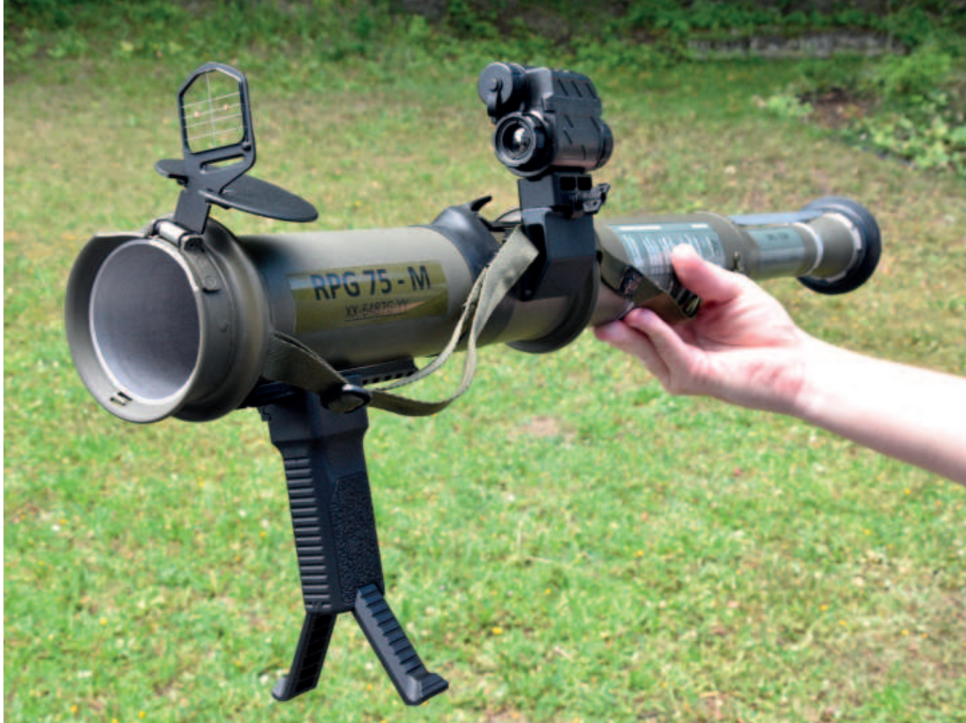
RPG-75 – nejslavnější výrobek, zbraň zavedená do výzbroje před padesáti lety, ale průběžně inovovaná – v současnosti se zaměřovačem, který umožňuje použití v noci – noční vidění, termovidení
