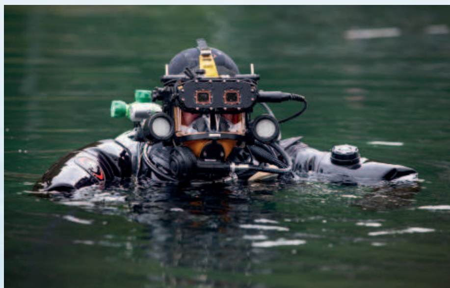
Potápěč s celoočejovou maskou s infračerveným zařízením určeným pro vidění v neprůhledných vodách
