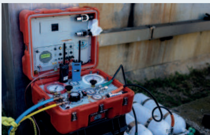
Kufr pro rozvod dýchacího média KMACS – Kirby Morgan Air control systém, součást přílbového setu Kirby Morgan
