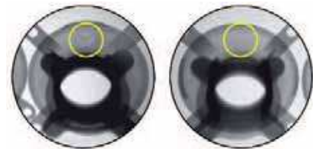
Porovnání rentgenových snímků odlitků původní a novou technologií
