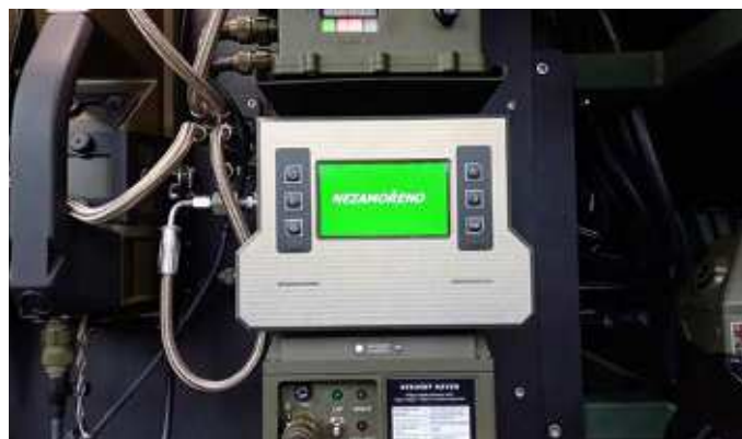
Vysoce citlivý detektor nervově paralytických látek DAPH
