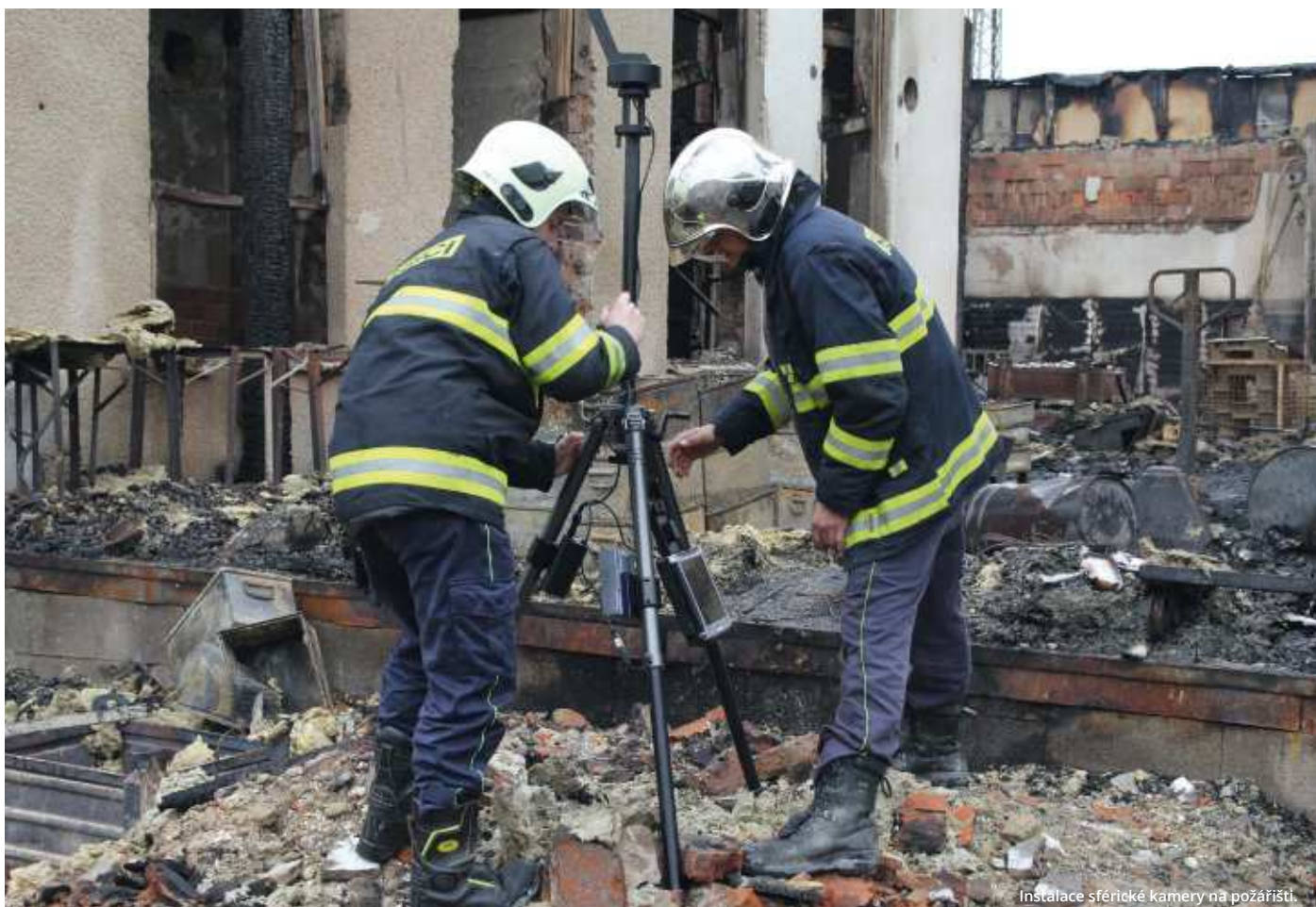
Instalace sférické kamery na požářišti.
