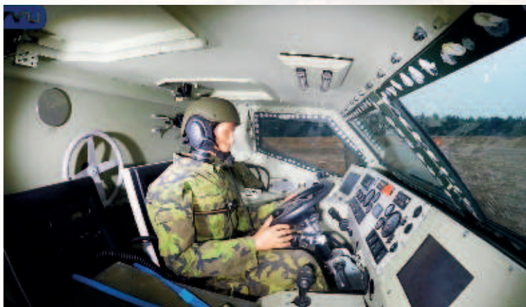
Antropomorfní testovací zařízení (instrumentovaná figurína) ve vozidle před výbuchovým testem
