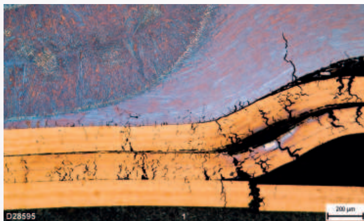
Expertýza praskání bodových svarů nerezového dílu vozidla
