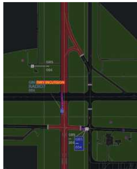
ERIS A: Detekce a výstraha před narušením nebo obsazením aktivní dráhy
