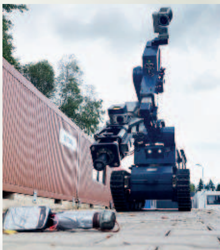
Výcvik s robotem tEODor – zneškodňování NVS
