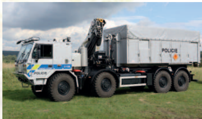
Přeprava PYRO techniky: dálkově ovládaný traktorbagr Huddig 1260C a Tatra 815-7 8×8 se zodolněným kontejnerem na převos munice
