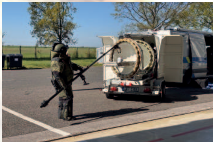
Nácvik vložení NVS do výbuchové komory Dynasafe
