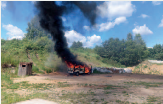
Funkční zkouška – zkoumání účinku výbuchu NVS ve vozidle
