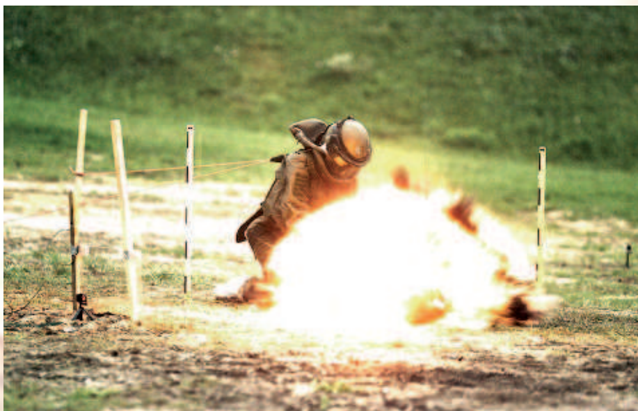
Zkouška balistické ochrany pyrotechnického obleku
