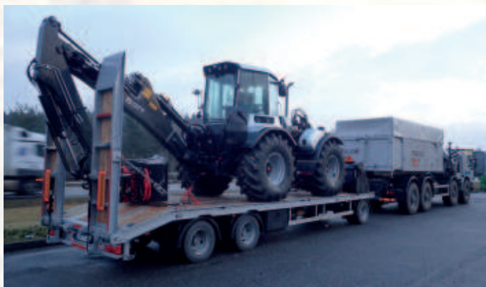
Přeprava PYRO techniky: dálkově ovládaný traktorbagr Huddig 1260C a Tatra 815-7 8×8 se zodolněným kontejnerem na převos munice
