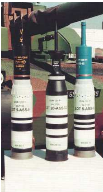
▲ Tanková munice ráže 120 mm od francouzské firmy GIAT zahrnuje podkaliberní průbojný náboj se šípovou střelou z ochuzeného uranu nebo karbidu wolframu a víceúčelový kumulativní náboj.
