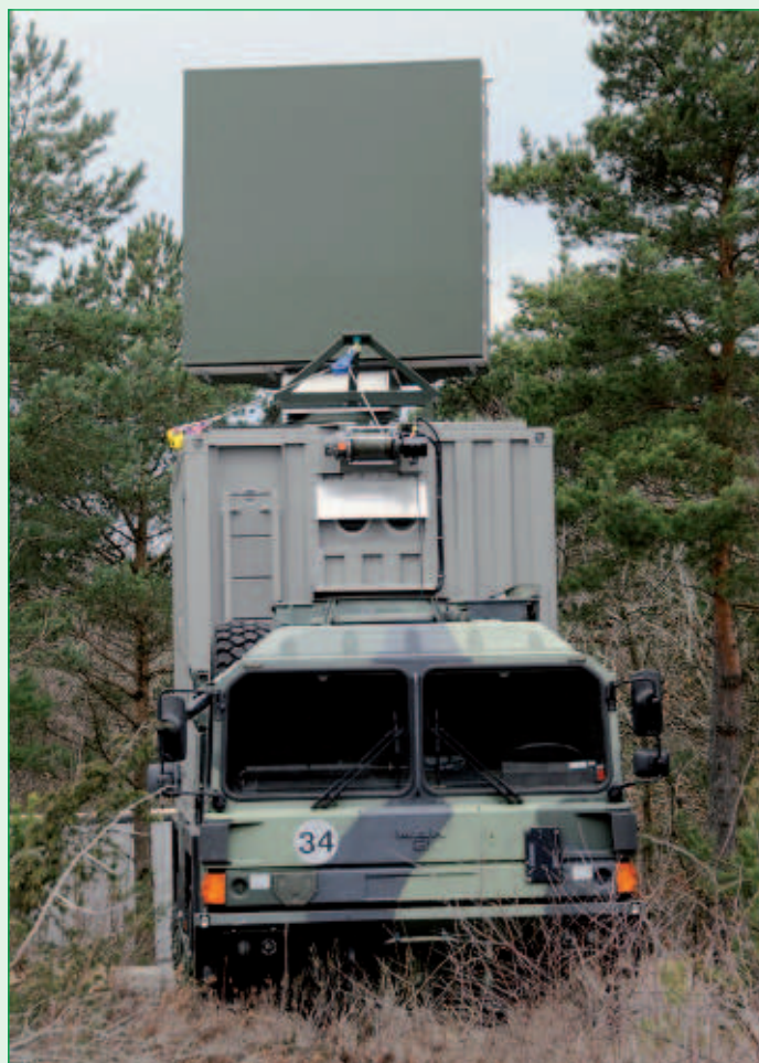
Radar typu MADR od společnosti Saab na podvozku MAN MADR unit by Saab, mounted on a MAN truck chassis
