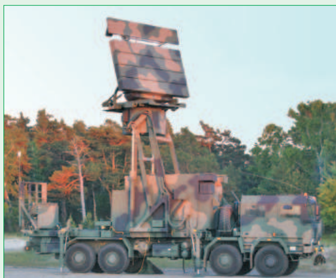
Polský projekt mobilního radaru typu MADR 3D na českém podvozku Tatra 8x8 The Polish MADR 3D radar project on a Czech Tatra 8x8 chassis
